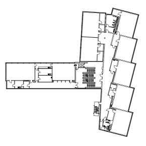
Bereits 1996 wurde an der kaufmännischen Berufsschule Beeckstraße ein erdgeschossiger Verwaltungsbau errichtet. Im Zuge eines zweiten Bauabschnittes wurde dieser Bereich um drei Geschosse aufgestockt. Die Statik des Verwaltungsgebäudes erlaubte diese Maßnahme. Sie wurde als konventionelle Mauerwerks-
