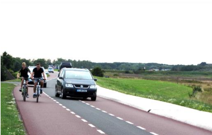
Abbildung 1: beispielhafte Fahrbahnmarkierung bei einer Rad-Vorrang-Route
